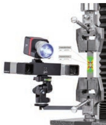
» Slika 5: Sistem GOM ARAMIS za merjenje pomikov in deformacij z digitalno korelacijo slike
